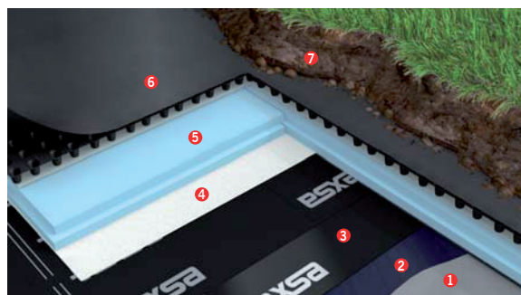
1. Warstwa spodnia 2. Grunt 3. Membrana hydroizolacyjna, np. VINITEX MAT 4. ROOFTEX 300 5. Izolacja 6. Drenaż 7. Warstwa humusu
